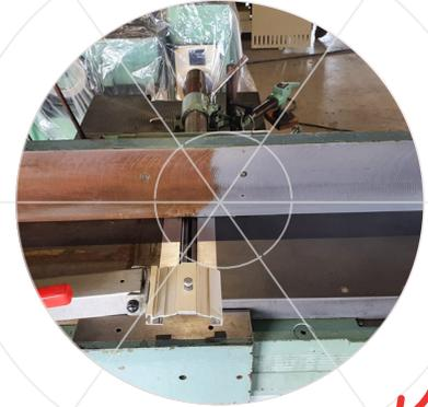
**Désoxydation d'une machine-outil**
